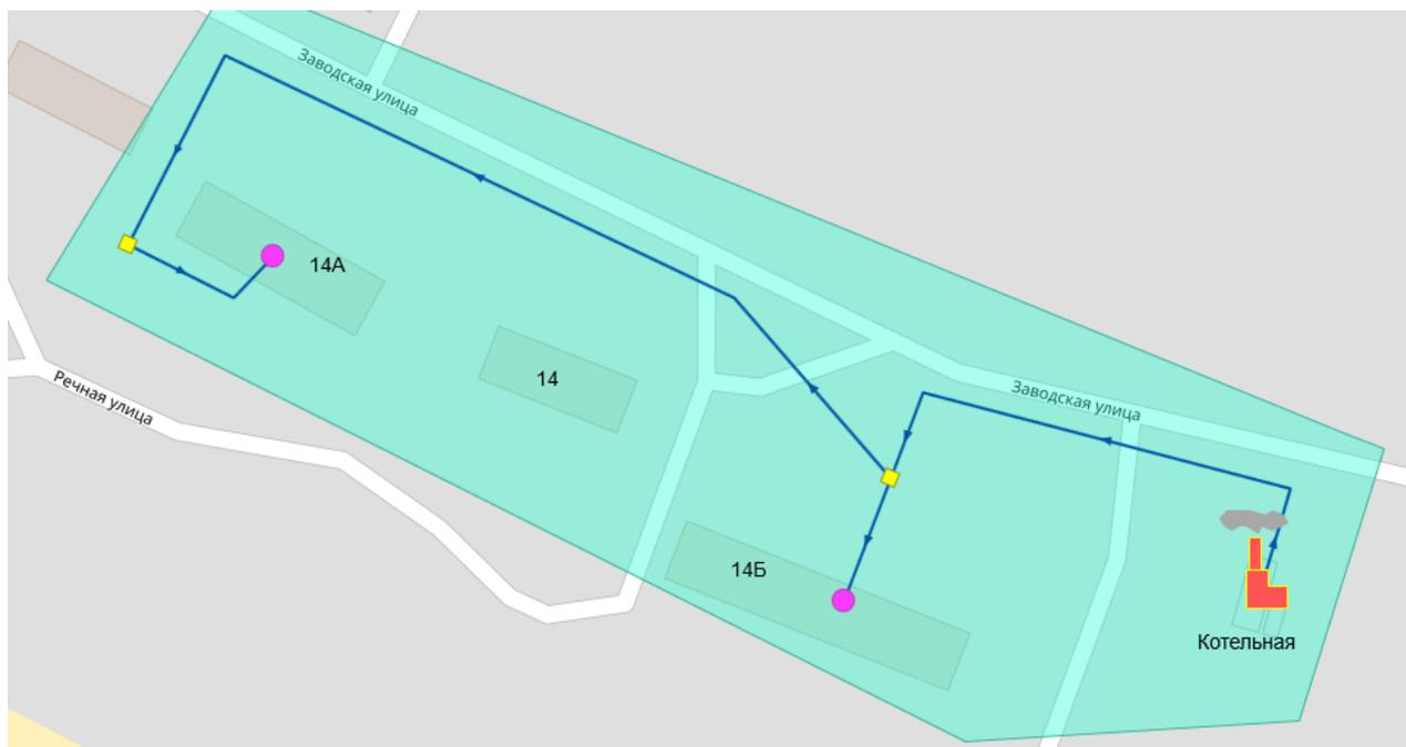
Рисунок 7. Схема теплосетей котельной п. Плоское
