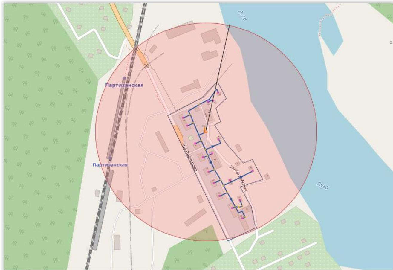
Рисунок 31. Радиус эффективного теплоснабжения котельной поселка городского типа Толмачево, микрорайона Тосики
