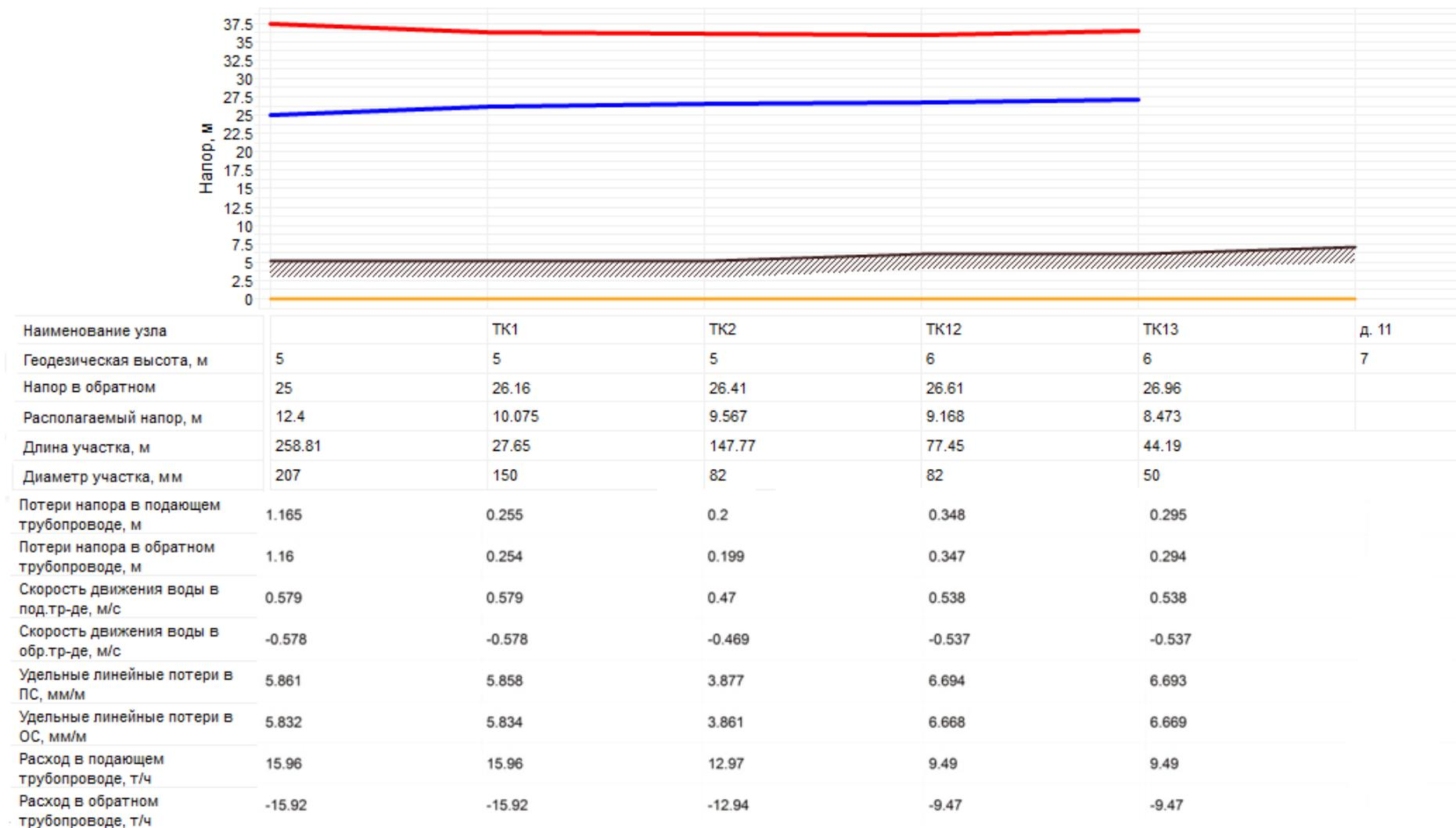
Рисунок 15 Фактический пьезометрический график от котельной д. Жельцы до дома № 11.
