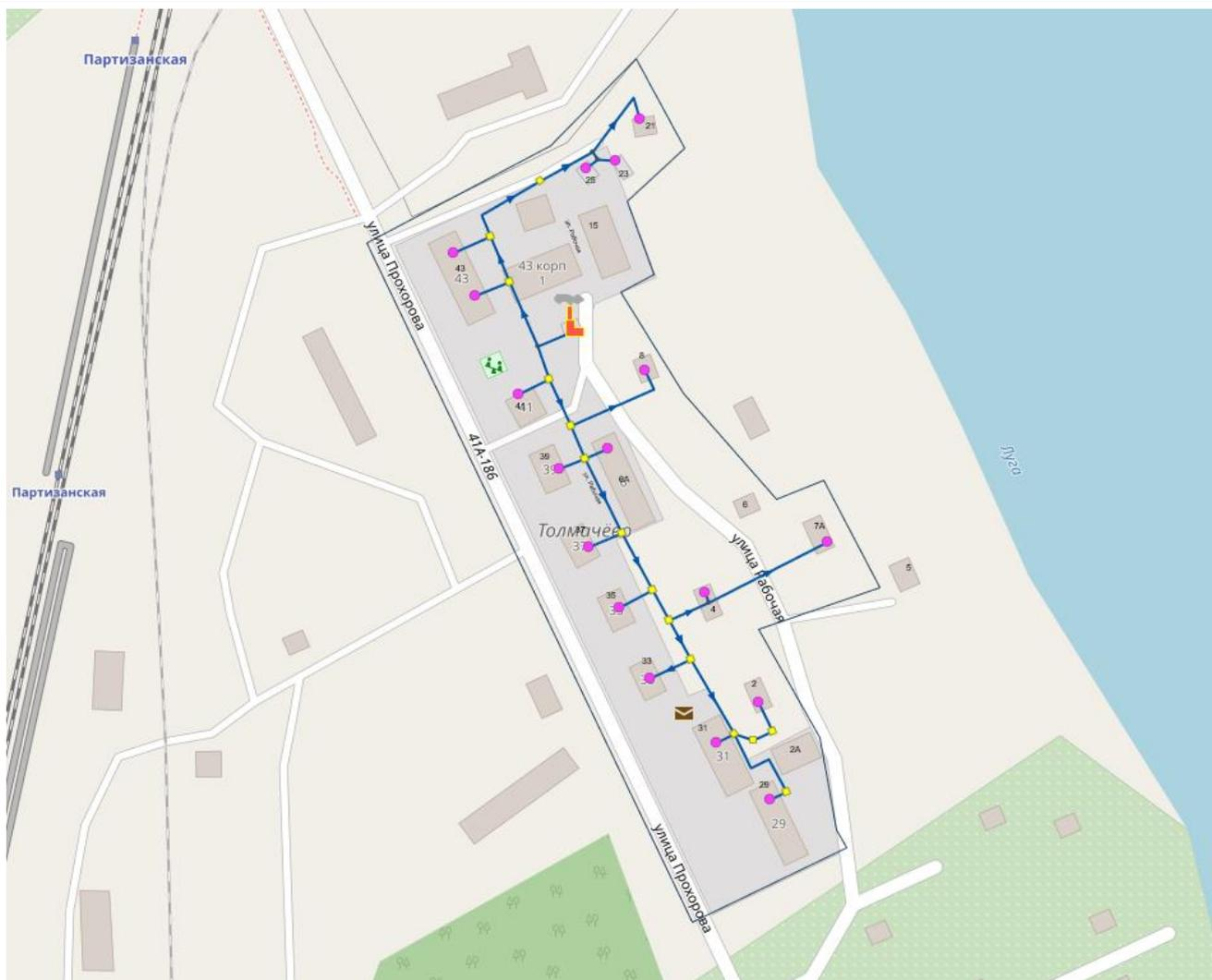
Рисунок 9. Схема теплосетей котельной пгт. Толмачево, мкр. Тосики
